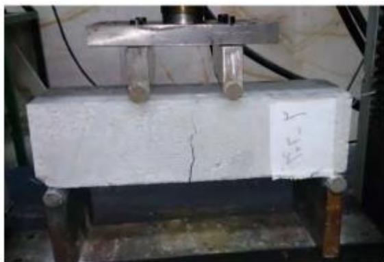
شکل ۵: تصویر یکی از نمونه های منشوری ساخته شده در حال تست
