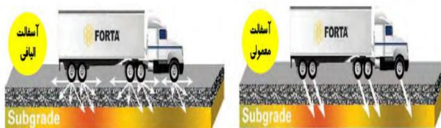
شکل ۱: عملکرد الیافها در آسفالت
